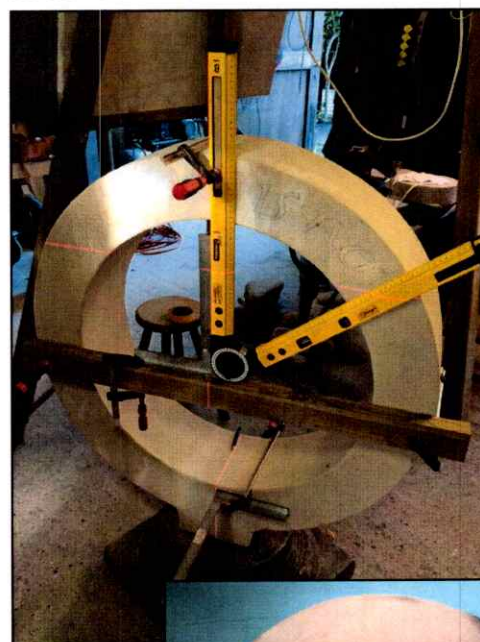
Foto 1: Uitlijnen met het laserwaterpas en de hoekmaat.
